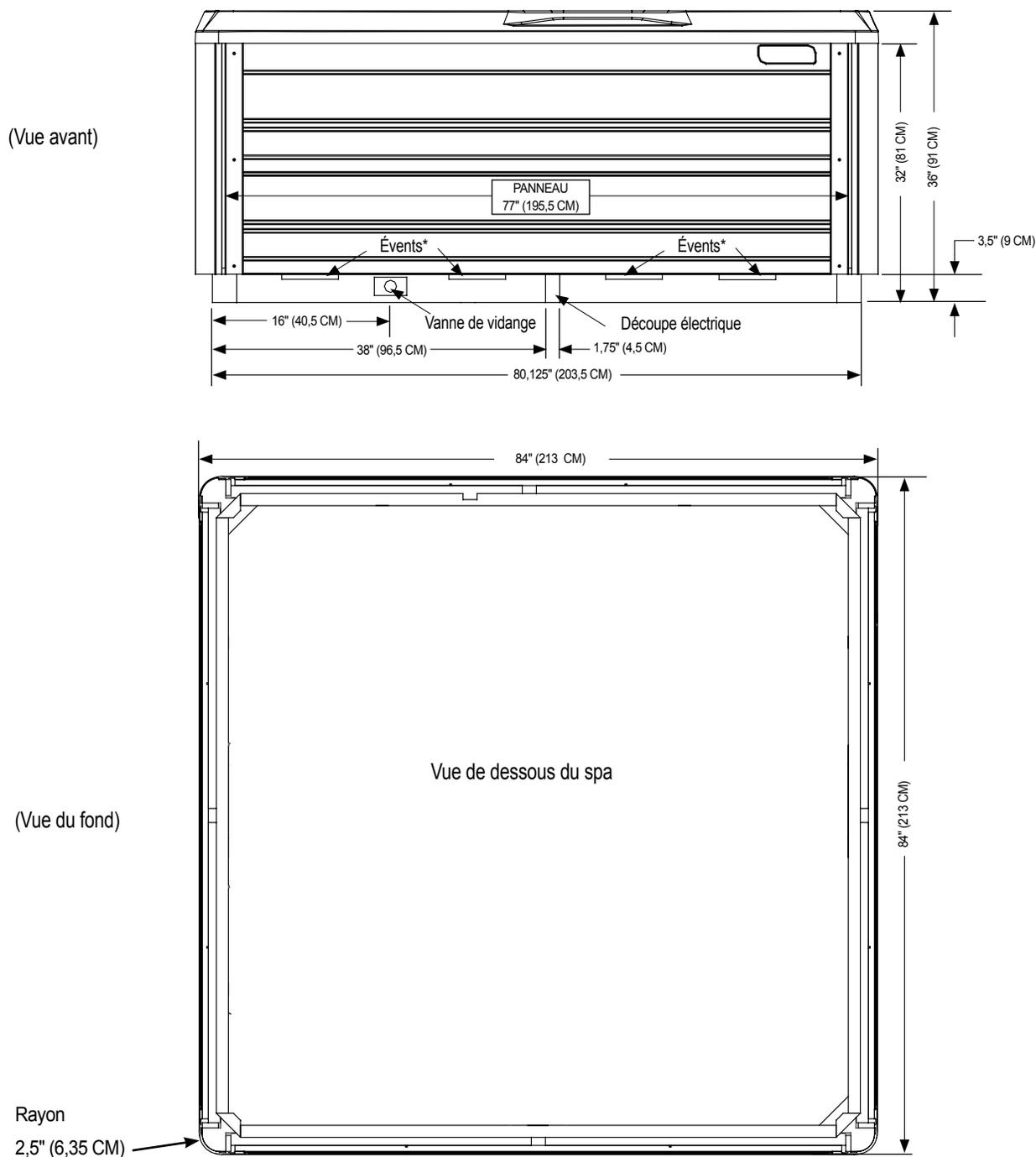
**REMARQUE :** WATKINS WELLNESS recommande que le spa FLASH soit installé sur une dalle en béton armé d'une épaisseur minimum de 10 cm ou sur une terrasse dotée d'une structure solide capable de supporter le « poids mort » indiqué dans le tableau des spécifications du spa.
