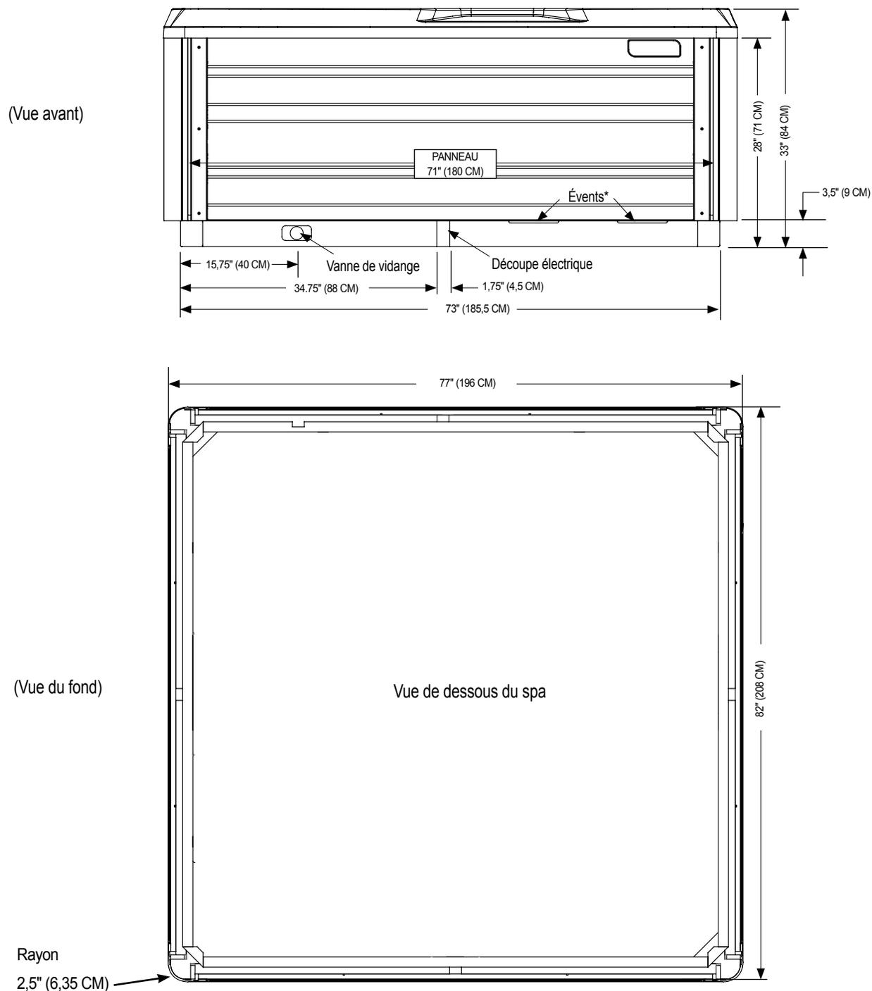
**REMARQUE :** WATKINS WELLNESS recommande que le spa **STROBE** soit installé sur une dalle en béton armé d'une épaisseur minimum de 10 cm ou sur une terrasse dotée d'une structure solide capable de supporter le « poids mort » indiqué dans le tableau des spécifications du spa.
