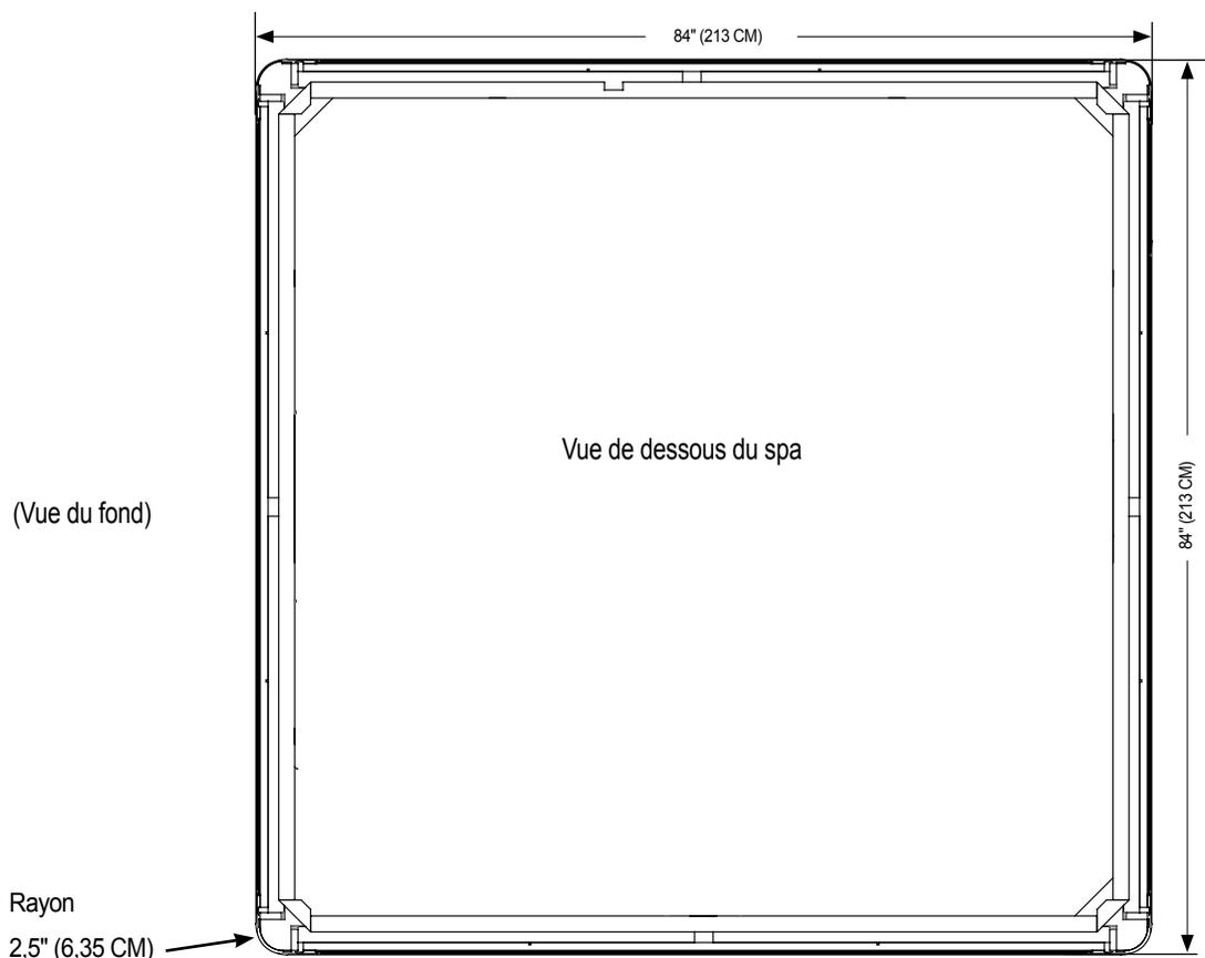
**REMARQUE :** WATKINS WELLNESS recommande que le spa FLAIR soit installé sur une dalle en béton armé d'une épaisseur minimum de 10 cm ou sur une terrasse dotée d'une structure solide capable de supporter le « poids mort » indiqué dans le tableau des spécifications du spa.
