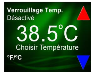
Si la valeur de la température définie ne change pas, vérifiez si les fonctions **VERROUILLAGE DE LA TEMPÉRATURE** ou **VERROUILLAGE DU SPA** sont activées. Si l'une ou l'autre de ces fonctions est activée, il est impossible de modifier la température.
