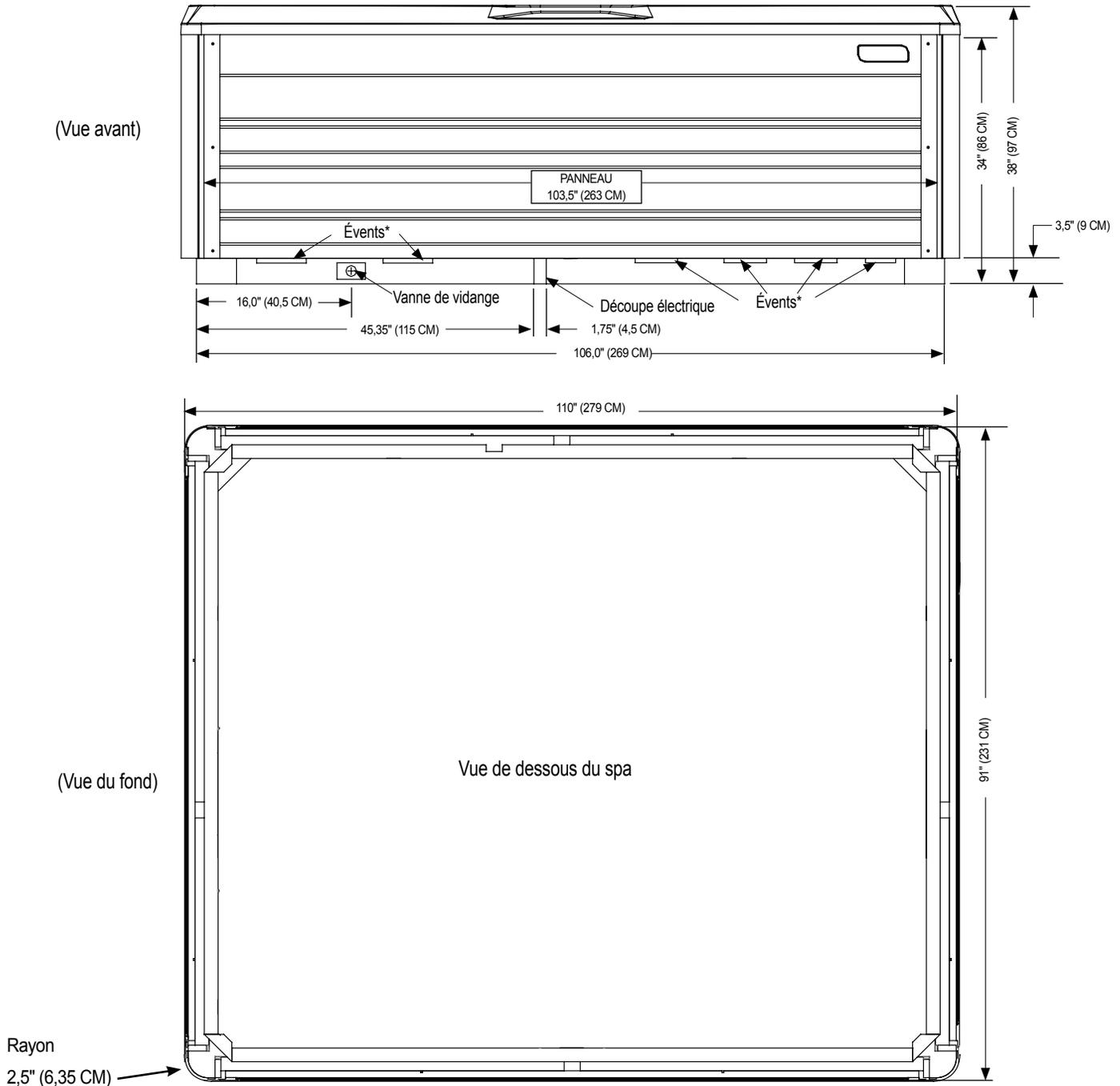
**REMARQUE :** WATKINS WELLNESS recommande que le spa **PRISM** soit installé sur une dalle en béton armé d'une épaisseur minimum de 10 cm ou sur une terrasse dotée d'une structure solide capable de supporter le « poids mort » indiqué dans le tableau des spécifications du spa.
