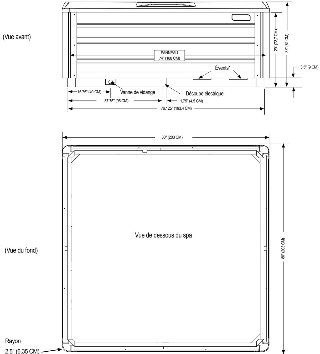
**REMARQUE :** WATKINS WELLNESS recommande que le spa **BEAM** soit installé sur une dalle en béton armé d'une épaisseur minimum de 10 cm ou sur une terrasse dotée d'une structure solide capable de supporter le « poids mort » indiqué dans le tableau des spécifications du spa.
