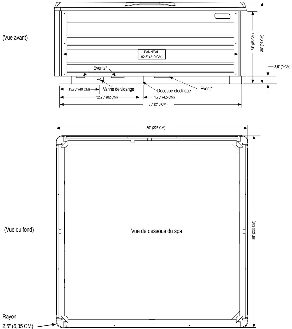
**REMARQUE :** WATKINS WELLNESS recommande que le spa **PULSE** soit installé sur une dalle en béton armé d'une épaisseur minimum de 10 cm ou sur une terrasse dotée d'une structure solide capable de supporter le « poids mort » indiqué dans le tableau des spécifications du spa.
