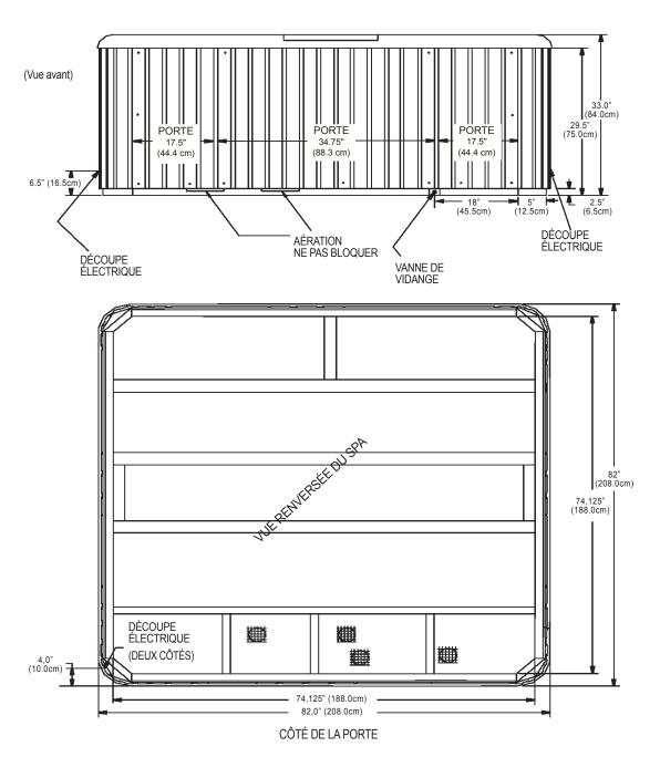
**REMARQUE:** Watkins Manufacturing Corporation recommande que le spa **PROPEL** soit installé sur une dalle en béton armé d'une épaisseur minimum de 10 cm ou sur une terrasse dotée d'une structure solide capable de supporter le « poids mort » indiqué dans le tableau des spécifications du spa.
