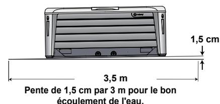
Il est important de noter que les surfaces meubles ont tendance à s'affaisser et que le spa ne sera donc plus de niveau, même lorsque des dalles de béton sont utilisées pour répartir le poids de manière homogène.
